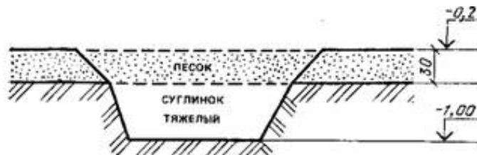
Рис. 7.18. Поперечное сечение траншеи для фундамента, изображенного на рис. 13.17 при залегании разнородных грунтов
