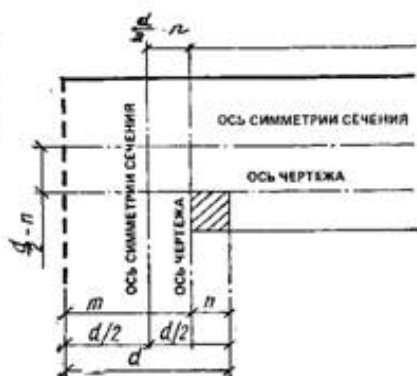
Рис. 7.14. Схема образования углового сопряжения со смещенными осями плана относительно осей симметрии сечений
