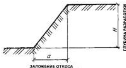
Рис. 7.7. Схема образования откосов при разработке траншей и котлованов
