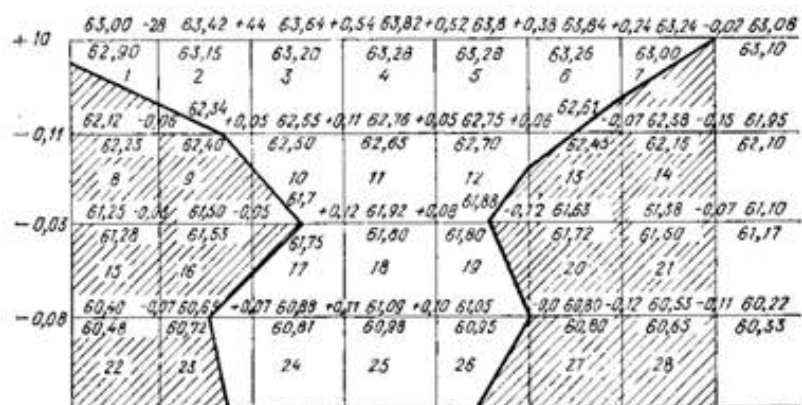
Рис. 7.3. Картограмма земляных работ при вертикальной планировке и подсчете земляных работ по квадратам
